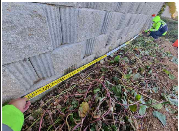
스토퍼를 이용한 구간분할 측정
