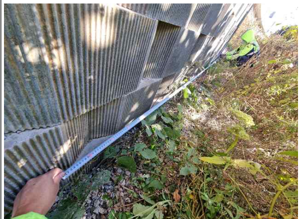
줄자를 이용한 구간분할 측정
