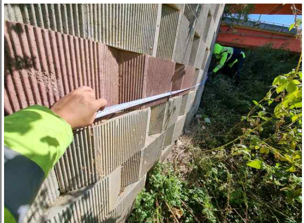
줄자를 이용한 구간분할 측정
