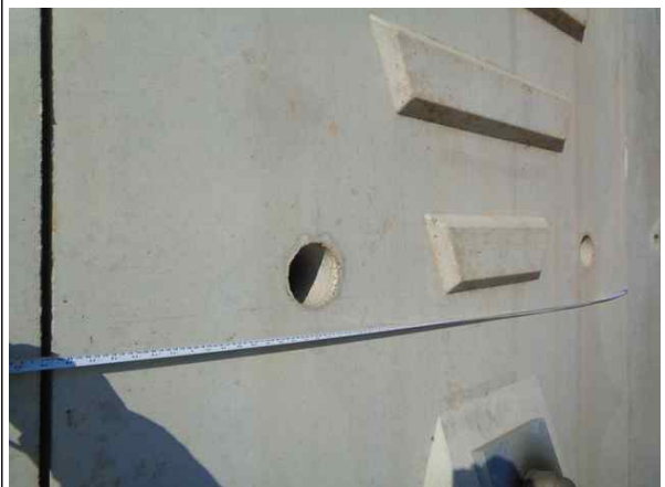
줄자를 이용한 구간분할 측정
